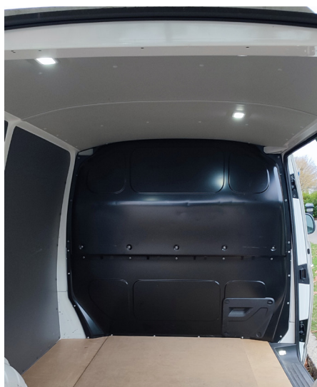
Das Entfernen der Trennwand stellt eine Veränderung des typgenehmigten Zustandes dar und ist genehmigungspflichtig.
